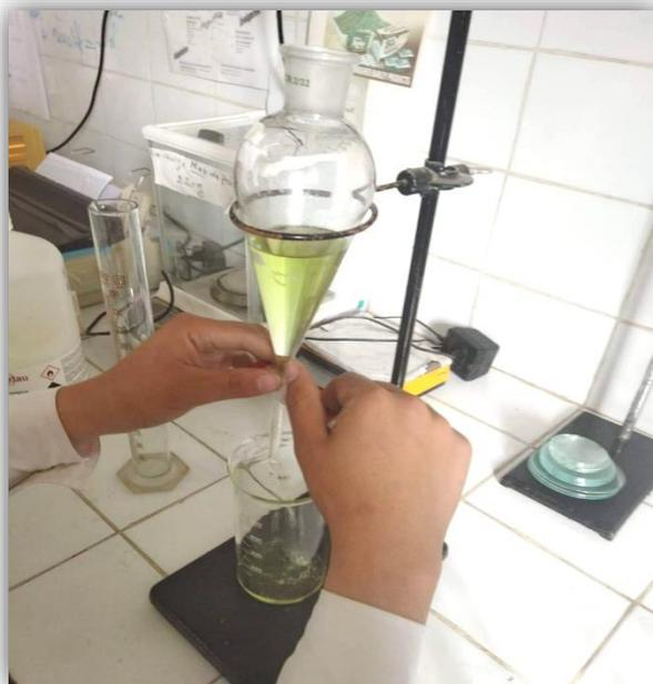
**Figure 15:** Affrontement par les solvants dans l'ampoule à décanter.
